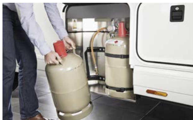
Coffret à bouteilles de gaz « easy change » profondément décaissé, facilitant le remplacement des bouteilles accessibles individuellement (sauf sur les modèles T 143 LE)
