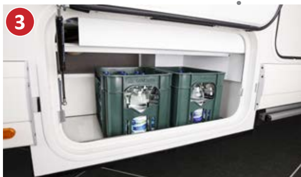
Grand rangement additionnel dans le double plancher avec porte de soute séparée
