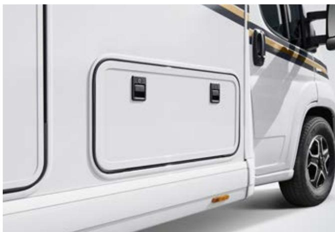
mit innenliegenden Scharnieren, plan in Karosserie integriert
