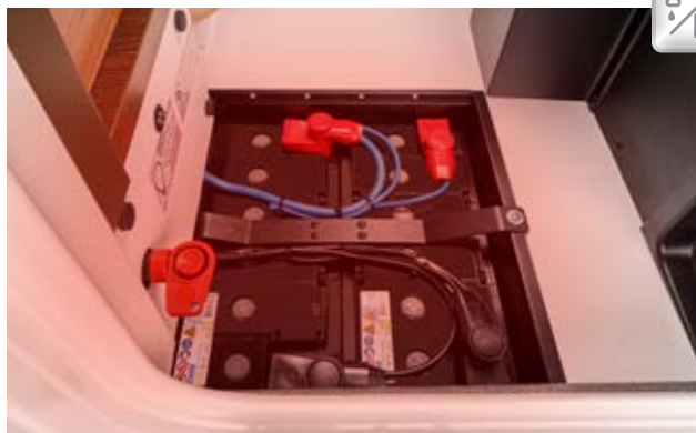
Accucentrale verwarmd met hoofdschakelaar. Standaard: gelaccu 2 x 80 Ah, goed toegankelijk geplaatst in de buitenbergruimte aan bijrijderszijde, optionele lithium-ion- accu, 90 Ah inclusief accucomputer en apart touchscreen
