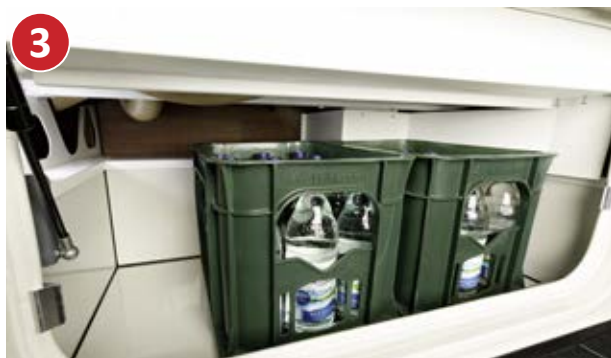
Grote, extra bergruimte in de dubbele vloer met aparte buitenklep
