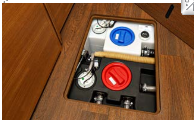
Watertanks vorstvrij in verwarmde dubbele vloer
