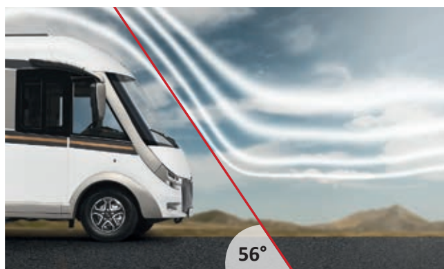
Driedimensioneel gevormd frontpaneel, vlakke invalshoek voor minder luchtweerstand, lager brandstofverbruik en minder windgeruis
