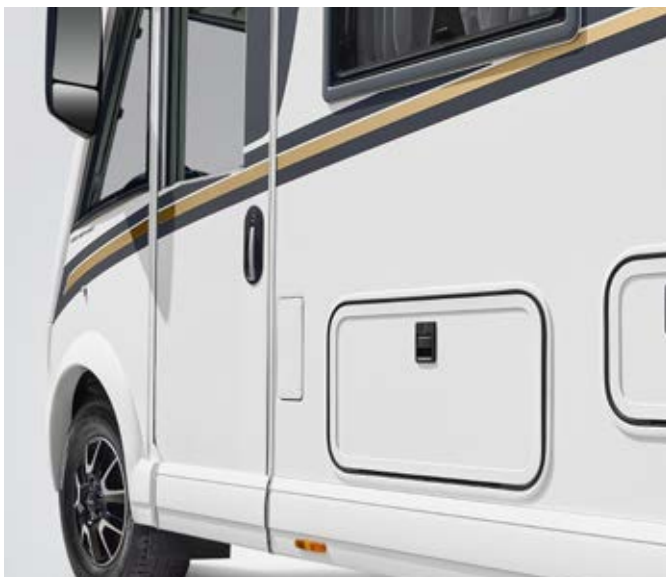
med invändigt liggande gångjärn – infällda i karossen
