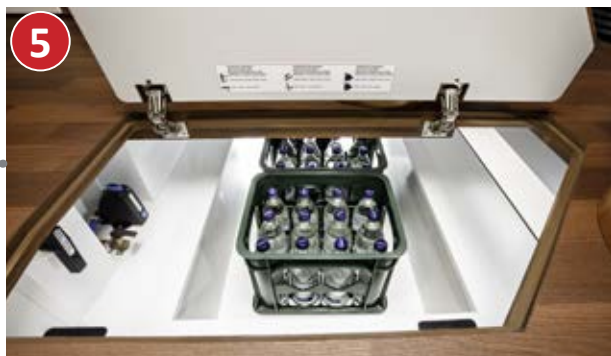
Groot luik in woonkamervloer bij de entree: met geopende XL-toegangsdeur comfortabel ook van buiten in te laden
