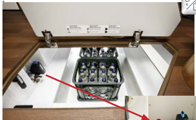
Centrale di controllo acque grigie accessibile anche dall'esterno tramite la porta della cellula XL
