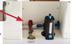
Centrale di controllo acque grigie accessibile anche dall'esterno tramite la porta della cellula XL
