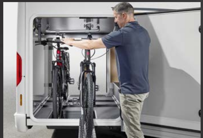
Facile carico di una Pedelec o uno scooter tramite il sistema di spinta con binario agganciabile
