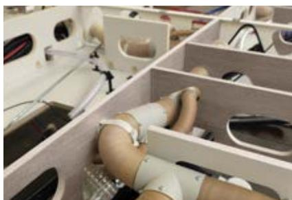
Massima stabilità e resistenza alla torsione, grazie al doppio pavimento Carthago con carrozzeria autoportante e telaio ribassato AL-KO speciale
