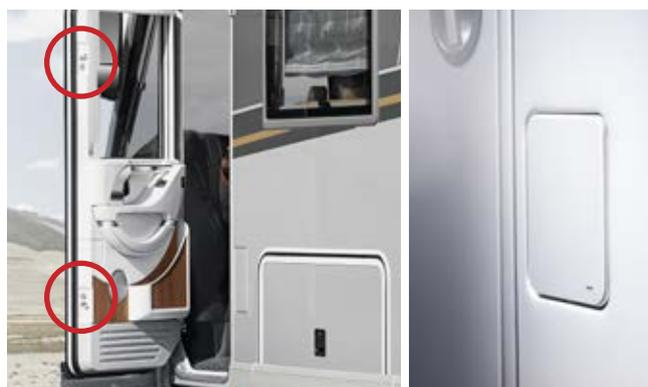
Porta della guida con ingresso extra basso e doppia chiusura di sicurezza. Tappo del serbatoio del carburante inserito a filo superficie nella fiancata
