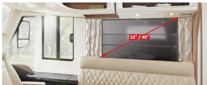
Sistema di estrazione TV dietro lo schienale della panca (32" o 40" a seconda del modello)\*
