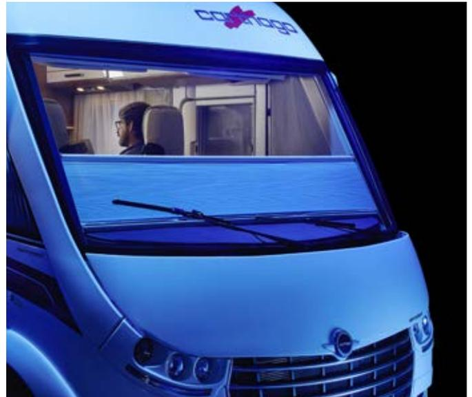
con tendina plissettata multifunzione per parabrezza a scorrimento orizzontale, con funzione di riparo dal sole, dagli sguardi indiscreti e oscurante con isolamento
