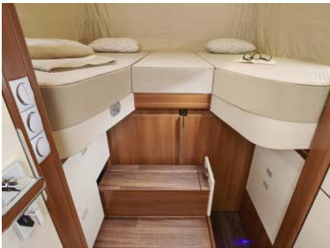
Letti singoli longitudinali abbassabili elettricamente con gradino di accesso estraibile e porte scorrevoli come isolamento termico
