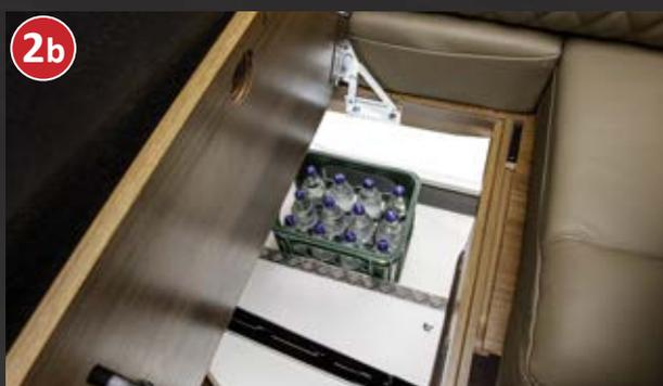
Facile prelievo del contenuto del vano di stivaggio dall'interno tramite coperchio apribile della panca del gruppo sedute a L con rivestimento brevettato
