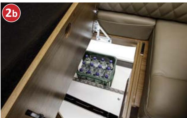
Facile prelievo del contenuto del vano di stivaggio dall'interno tramite coperchio apribile della panca del gruppo sedute circolare con rivestimento brevettato
