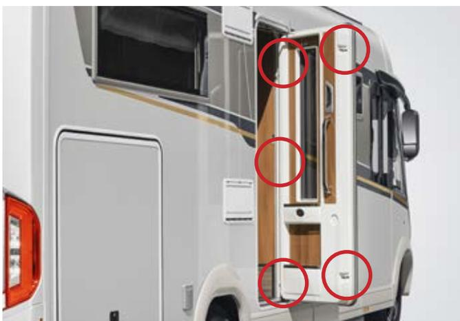
con porta extra robusta e resistente, passaggio più ampio da 63 cm, grande finestra nella porta, doppia chiusura di sicurezza, tre cerniere in acciaio a parallelogramma robuste, tendina plissettata oscurante integrata e zanzariera avvolgibile
