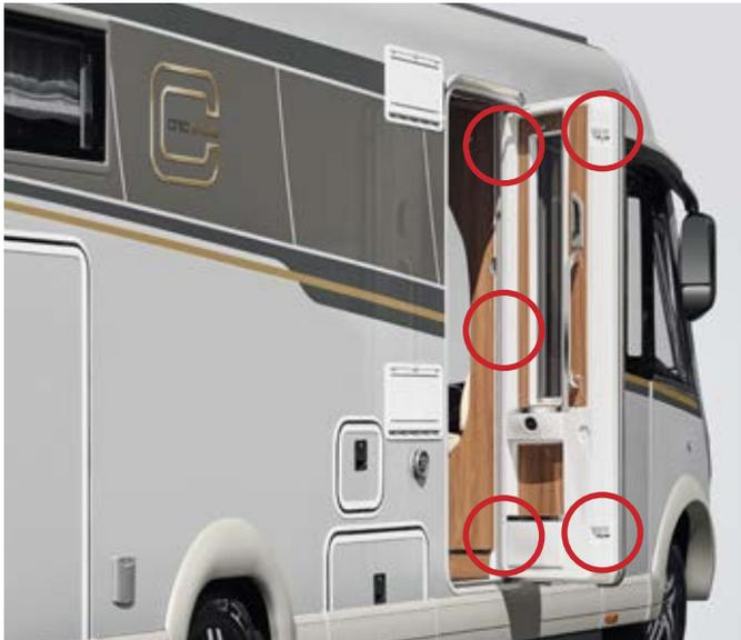
con porta extra robusta e resistente, passaggio più ampio da 63 cm, grande finestra nella porta, doppia chiusura di sicurezza, tre cerniere in acciaio a parallelogramma robuste, tendina plissettata oscurante integrata e zanzariera avvolgibile
