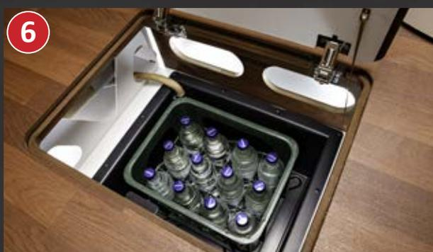
Botola nel pavimento della zona giorno con box di stivaggio per doppio pavimento (42 cm di profondità utile) nel doppio pavimento riscaldato
