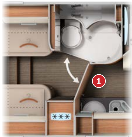
La porte du cabinet de toilette ① sert de séparation entre l'espace séjour et la chambre tout en créant un dressing à l'abri des regards
