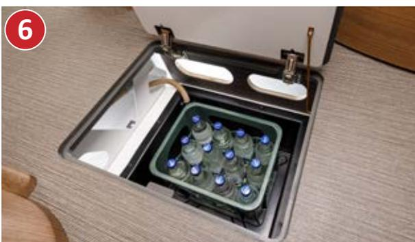
Trappe dans le double plancher chauffée de l'habacle avec caisse de rangement (prof. utile 42 cm)
