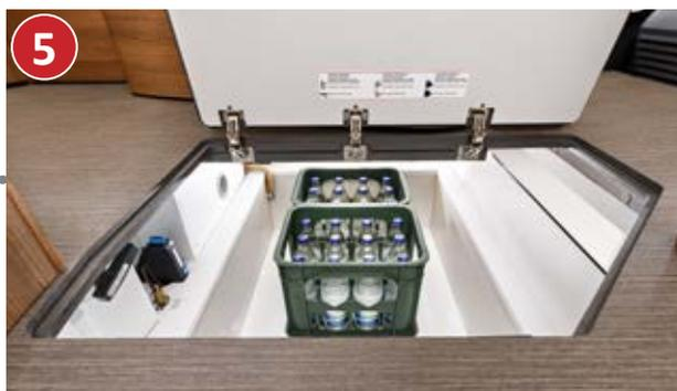
5 Trappe géante dans le plancher de l'habitacle au niveau de l'entrée : aisément chargeable depuis l'extérieur lorsque la porte de cellule XL est ouverte
